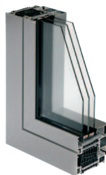
MB 104 Szerokość ramy 95 mm. Bardzo dobra izolacja akustyczna oraz termiczna, U_w od 0,53 W/m^2K .
