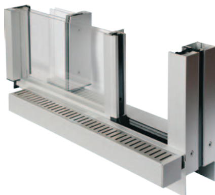
Artline / Artline XL System drzwi przesuwnych o wysokich parametrach termoizolacyjnych z wąską ramą w obrębie styku skrzydeł (26 lub 38 mm).
